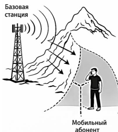
Рисунок 2. Влияние рельефа на распространение радиосигнала
